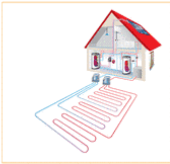
Wärmepumpe mit horizontalen Erdreichkollektor
